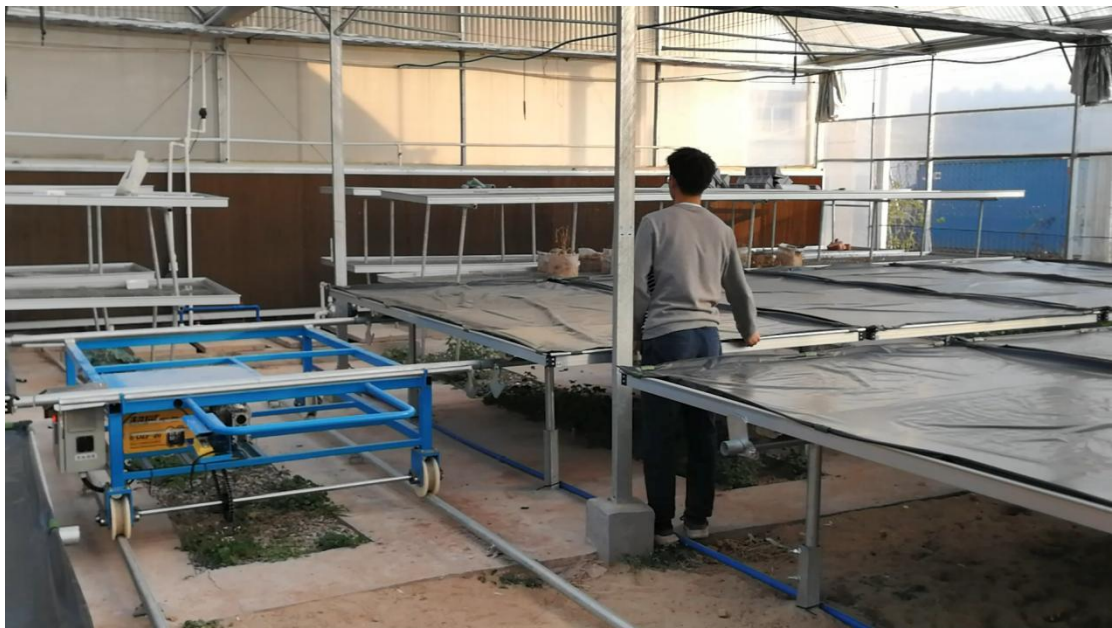
移动苗床轨道上移动苗床
