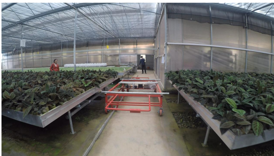
温室内部大型移动苗床搬运车遥控行走
