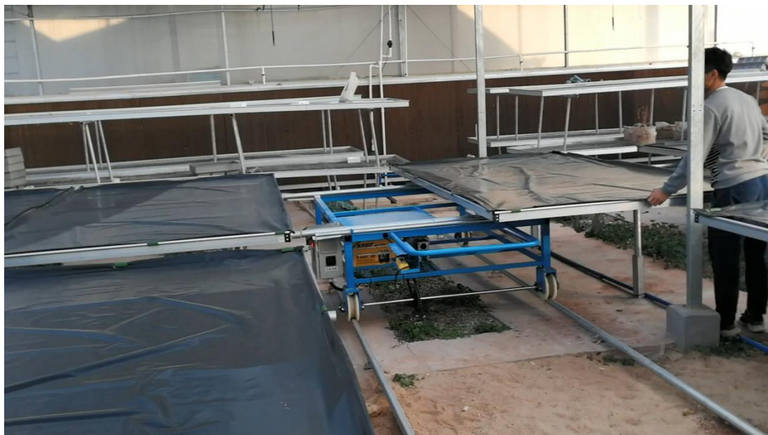
将移动苗床推上/推下移动苗床搬运车
