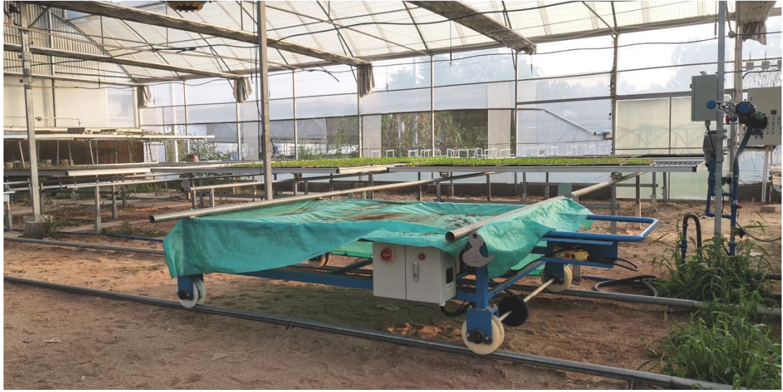
生产应用中的移动苗床输送装备系统
